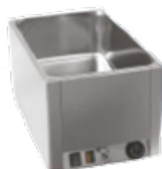
Nádoba ohrevná výdajná, vaňa pre gastronádobu GN1/1 150mm (nie je súčasťou stroja), regulácia teploty 30-90°C, kontrolka zapnutia a vyhriatia, ohrevné teleso pod dnom vane, výpustný kohút
